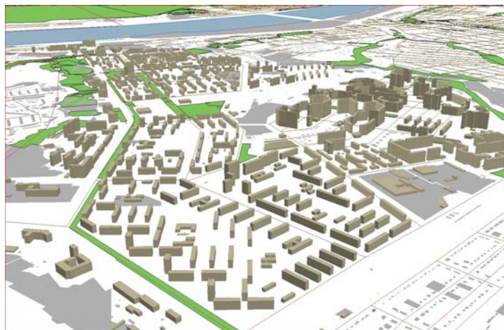
Рис. 1. Трехмерная визуализация территории г. Перми с учетом искусственных сооружений, используемых для акустических расчетов
